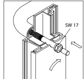
2. Unterlegscheibe auf Spezialschraube aufstecken und in gegenüberliegenden Griff festdrehen.
