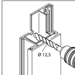
1. Mit 12,5 mm Bohrer bohren.
