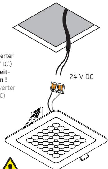
Der elektrische Anschluß darf nur vom Fachmann ausgeführt werden!
